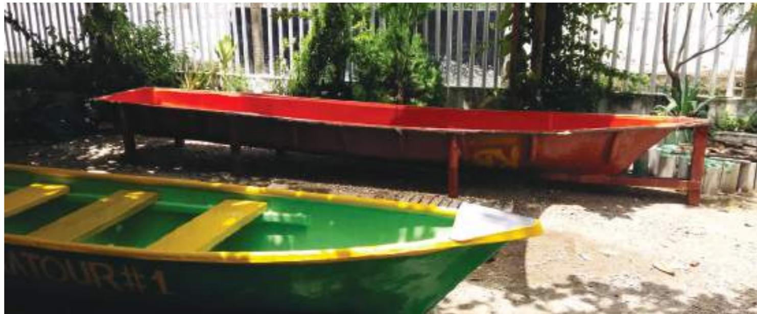
Ilustración 99. Molde para producción de canoas
