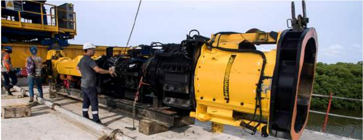
Ilustración 64. Martillo hidráulico
