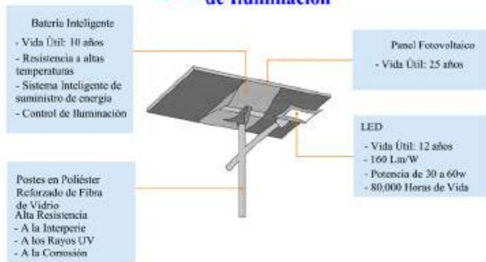
Ilustración 68. Panel solar tipo
