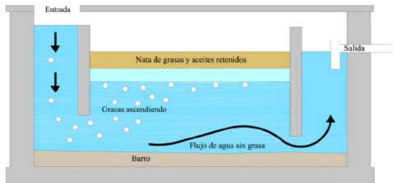
Ilustración 27. Comportamiento de una trampa de grasas
